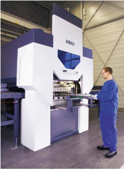
Рис. 6. Приспособление для быстрой замены валцов обеспечивает простую замену правильных валцов и значительно облегчает очистку правильного агрегата
