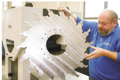
Рис. 3. Править можно все металлы с разрывным удлинением не менее 5% и выраженным пределом текучести
