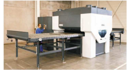
Рис. 7. В современных правильных станках, работающих с модульной системой подачи, правильные валцы расположены в верхней и нижней вальцовой станине, и оператору необходимо только установить значения для позиций загрузки и выгрузки на станке
