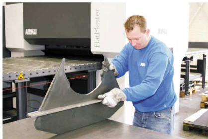
Рис. 1. Правка вальцами по сравнению с правкой прессом – более простой и быстрый способ получения ровных деталей с высокой точностью
